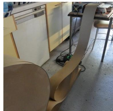
Dans un cas comme dans l'autre, il est important de bien positionner la bobine dans l'axe du chemin de défilement pour faciliter le passage du carton
