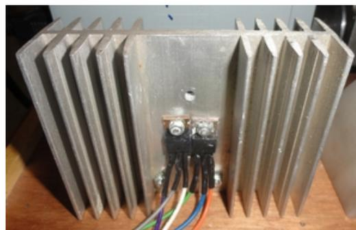
Dans ce cas, le radiateur sera au potentiel des drains et il ne faudra pas qu'il touche une autre partie métallique de la perforatrice.
