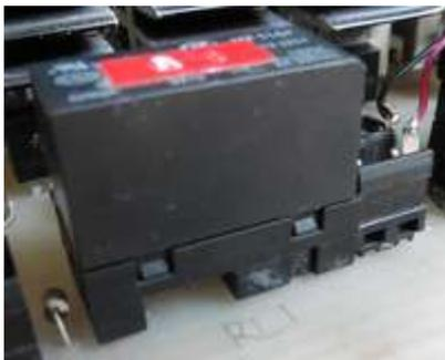
Les deux relais sont eux aussi montés sur support pour faciliter leur remplacement
