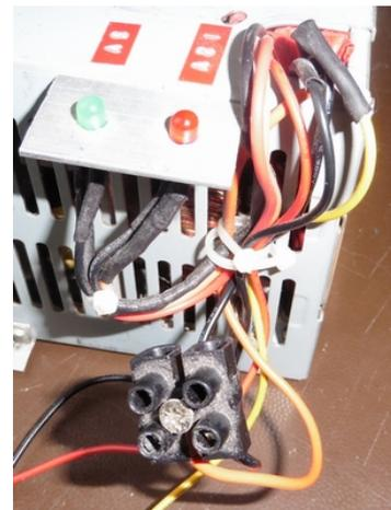
De plus, avec des fils volants, il y a aussi un gros risque d'arrachage lorsque le chariot part complètement en position arrière.
