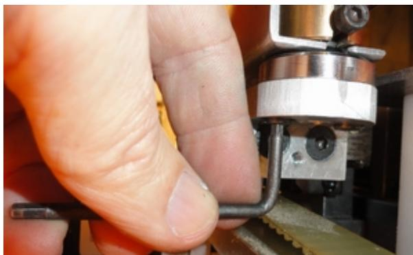
Lors de la mise en place, on amènera manuellement (moteur coupé) le poinçon en position basse, et ce n'est seulement qu'à ce moment là que les vis seront serrées à bloc.
