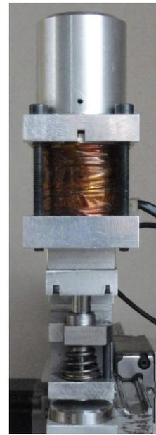
Un grand nombre de ressorts a été testé. Si le ressort est un peu faible, on peut toujours le remplacer par un plus costaud. Mais on ne peut pas impunément augmenter la puissance de ce ressort, car sa force vient se retrancher à la force avec laquelle descend le poinçon.
