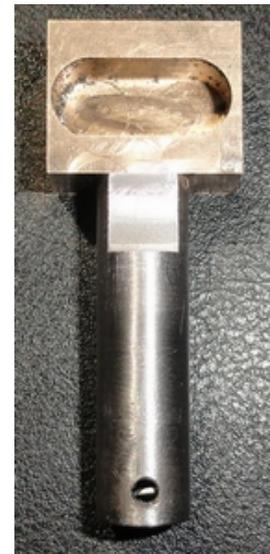
La profondeur d'usinage doit être tout juste supérieure au diamètre du roulement à aiguilles.
