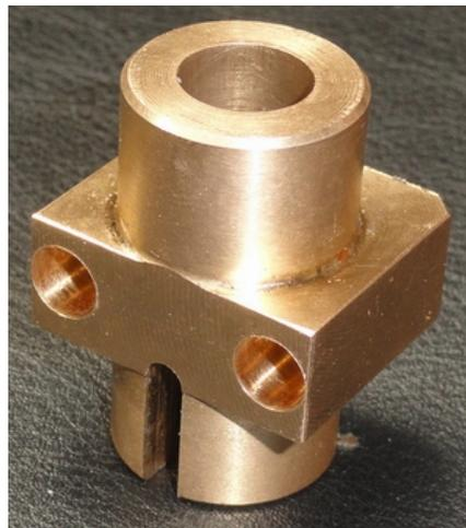
L'entaille faite à la base permet de laisser coulisser la vis de fixation du poinçon.
