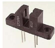
La source de lumière est permanente. Si aucun obstacle ne vient se placer entre elle et la cellule, cette dernière va envoyer un ordre au logiciel par l'intermédiaire de la carte d'interface.
