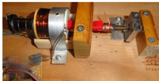
Nous avons fabriqué ensuite un joli support en alu pour maintenir la bobine en place, ainsi qu'un sérieux système de guidage pour le noyau dont l'extrémité venait taper comme un marteau sur le support de poinçon.
