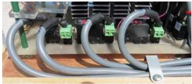
Les 6 fils de chaque moteur pas à pas sont insérés dans un tuyau plastique transparent.
