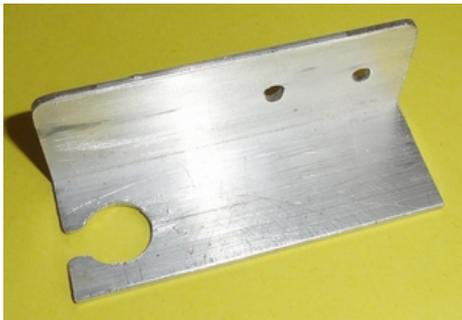
La pièce est percée largement pour laisser passer le poinçon. L'entaille faite en bout est là pour ne pas venir en conflit avec la vis de blocage du poinçon.
