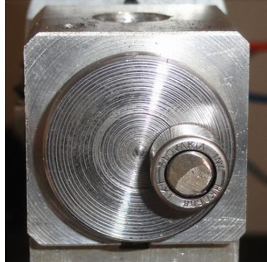
Un mini roulement à aiguilles est glissé sur l'axe.
