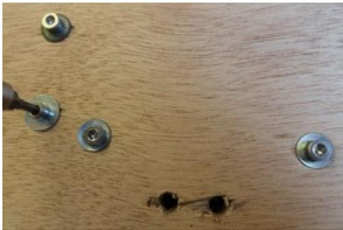
Chaque sous-ensemble de la perforatrice est solidement vissé. Des trous supplémentaires permettent d'atteindre les vis de fixation des paliers du rouleau entraîneur.
