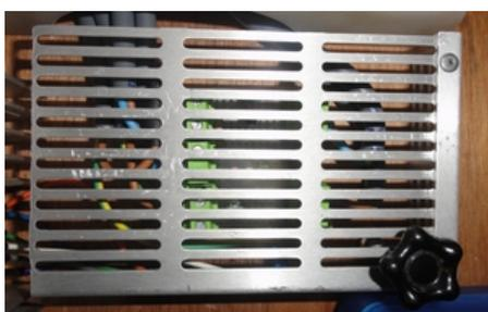
Un capot de protection recouvre la carte MOSFET. Il est réalisé avec une chute de tôle ajourée et récupérée sur un ancien appareil.
