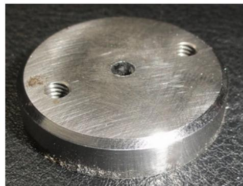
Pour éviter que le poinçon ne frotte sur toute l'épaisseur de la pièce, la partie où il coulisse a été réduite à 2 millimètres en faisant un trou conique sur sa face inférieure.
