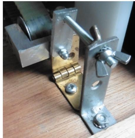
La fixation de la bride : La courroie est percée en son milieu. Une bride est fabriquée en tenant compte de l'espacement et de la forme des dents.
