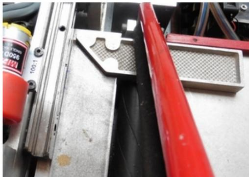
Toutes les vis doivent être fermement serrées pour éviter les vibrations et les bruits générés par les moteurs pas à pas.
